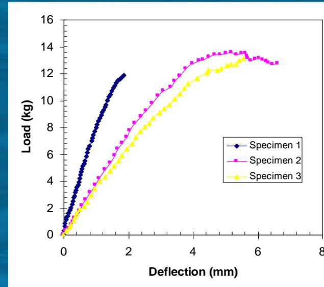
**LOAD/EXTENSION CURVE FOR CAST RESIN IN FLEXURE**
